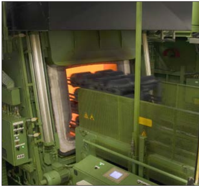
Batchugn med kontrollerad atmosfär. Foto: Bodycote Stockholm, Sverige.
