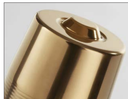
CVD TiC/TiN. Foto: Eifeler Werkzeuge, Tyskland.
