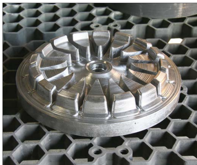
Undre formhalva för aluminiumfälg på galler före värmebehandling. Foto: ASSAB Çelik (Turkiet)
