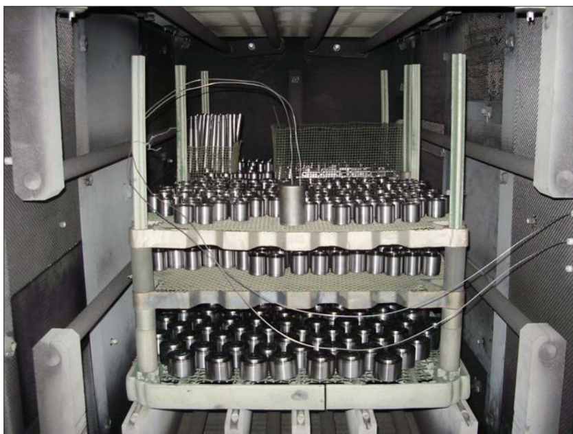
Termoelement gör det möjligt att mäta temperaturen i olika områden under värmebehandling. Foto: Böhler-Uddeholm Tjeckien
