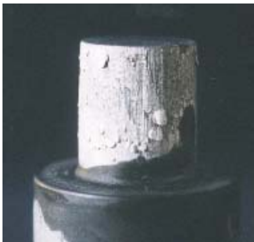
Pålödningsproblem på kärna.
