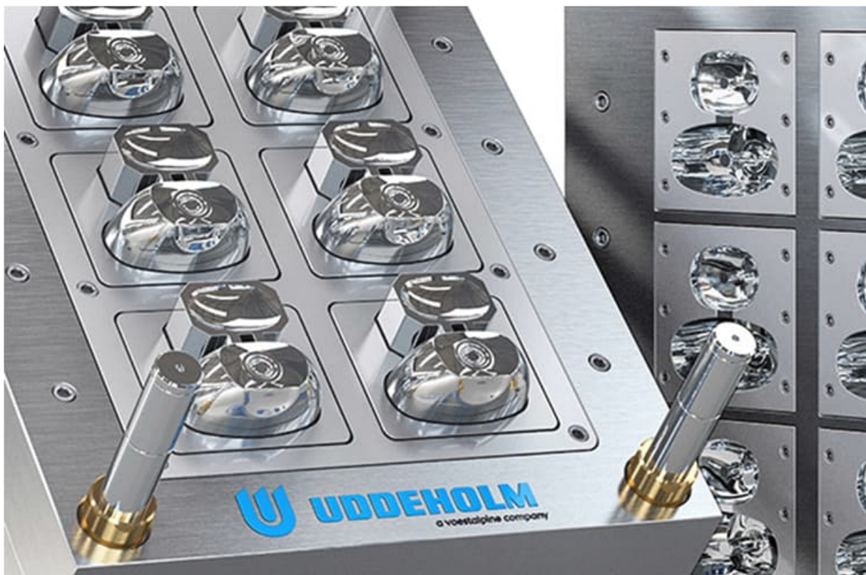
Obrázok: zjednodušené vyobrazenie vstrekovacej formy
