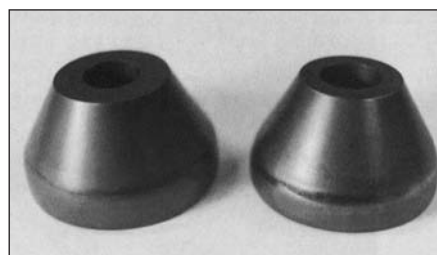
Nástroje z Uddeholm VANADIS 23 s PVD povlakom pre výrobu rúr tvárnením za studena
