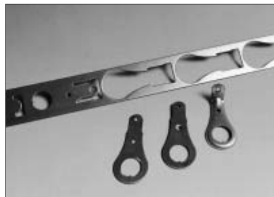
Attache en acier inoxydable estampé avec du Uddeholm Vanadis 23 pour la matrice et Uddeholm Vanadis 4 Extra pour le poinçon.
