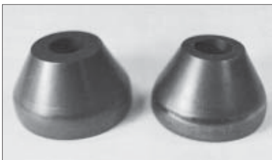
Outillage en Uddeholm Vanadis 23 revêtu de PVD pour le formage à froid de tubes.
