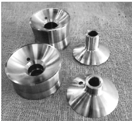
Pressscheiben aus Uddeholm QRO 90 Supreme.
