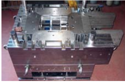
Utillaje fabricado con Uddeholm Nimax para la producción de un cuadro de conmutadores eléctricos.
