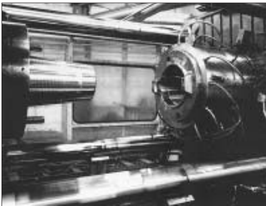
Eine große Form zur Herstellung eines Waschkorbs. Uddeholm Impax Supreme ist für die Herstellung dieses Werkzeugs geeignet.
