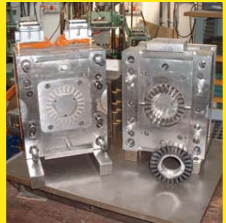
Inserts en Uddeholm Unimax moulé par injection pour la fabrication de rotors.
