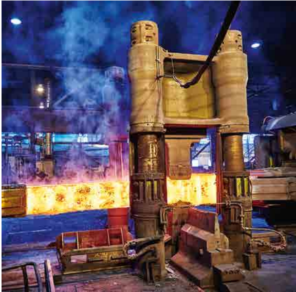
Schmieden von hochwertigen Warmarbeitsstählen im Uddeholm Stahlwerk in Schweden
