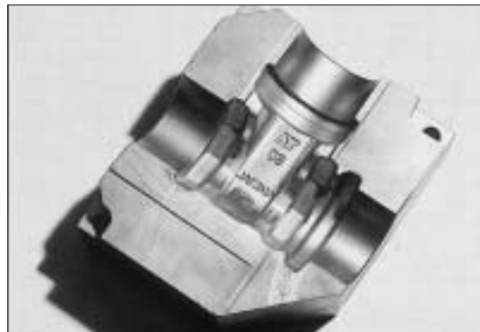
Вставки, изготовленные из Uddeholm QRO 90 Supreme.
