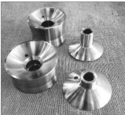
Пресс-шайбы, изготовленные из Uddeholm QRO 90 Supreme.
