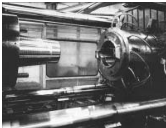
Пресс-форма для изготовления бельевых корзин. Подходящая сталь для такого инструмента – это Uddeholm Impax Supreme.
