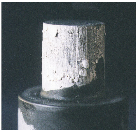
Poškodenie jadra nalepeným hliníkom.
