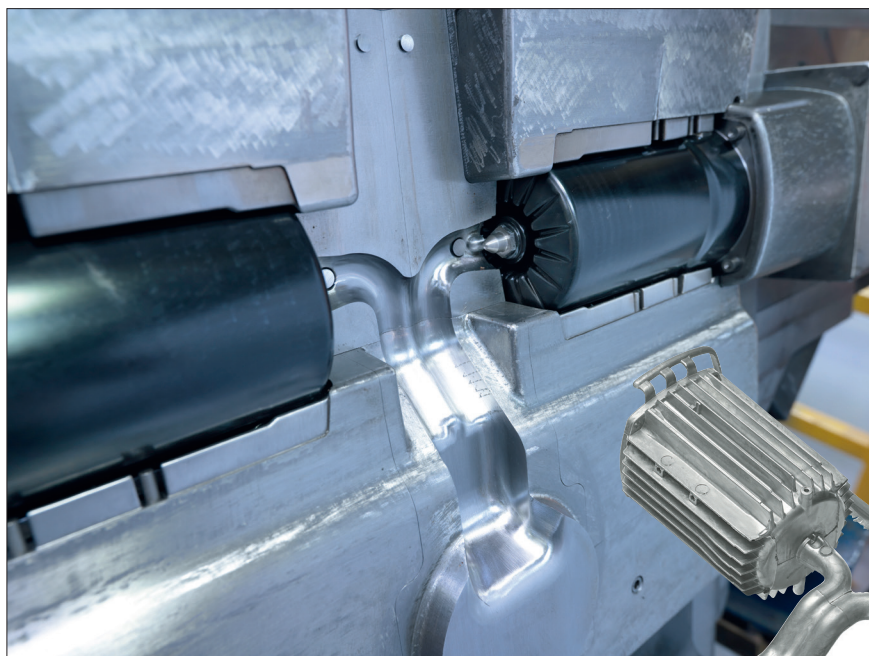
Hliníkový odliatok krytu čerpadla s vtokovou sústavou.
