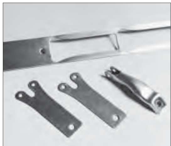
Halterung aus rostfreiem Stahl. Die Matrize wurde aus Uddeholm Vanadis 23 hergestellt, der Stempel aus Uddeholm Vanadis 4.
