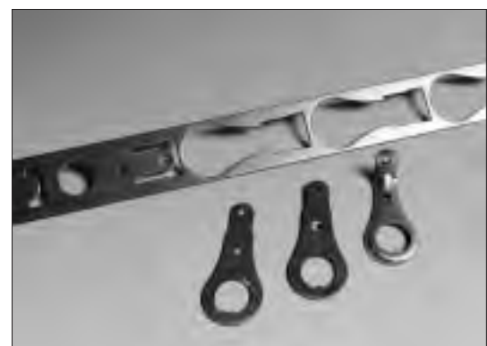
Halterung aus rostfreiem Stahl. Die Matrize wurde aus Uddeholm Vanadis 23 hergestellt, der Stempel aus Uddeholm Vanadis 4.
