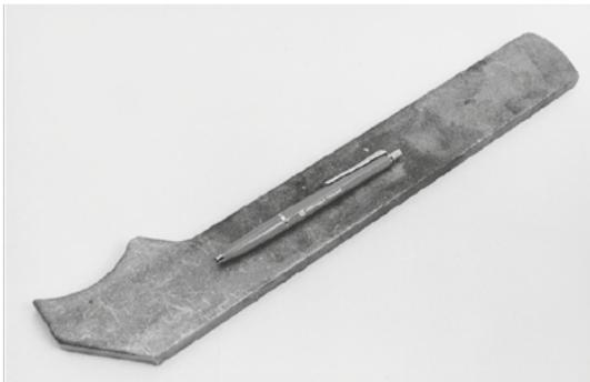
Ein Tragarm, der in einem Stanzwerkzeug aus Uddeholm Viking gefertigt wurde.
