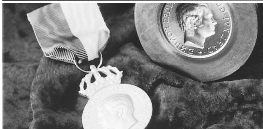
Kaltarbeitsprodukt, bei dem Uddeholm Calmax eine gute Wahl für die Matrice wäre.
