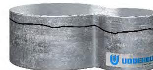
**EROSIONE/CORROSIONE:** sinergia tra fenomeni fisici e chimici che generano degrado della superficie dello stampo.
