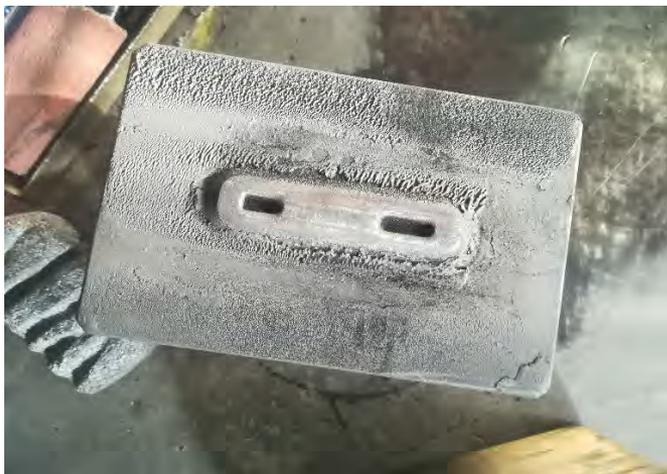
L'erosione è il risultato di fenomeni di usura a caldo, principalmente causati dallo scorrimento della lega processata sullo stampo e dipende da:
