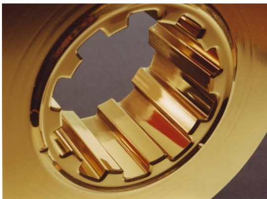
Stempel for massivformgivning belagt med CVD TiC
