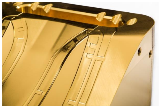
Sprøjtstøbeværktøj belagt med TiN Ultrafine
