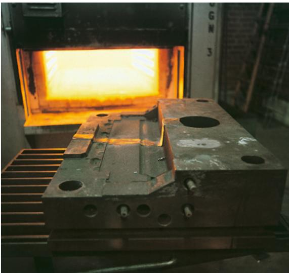
Wärmebehandlung einer Druckgussform nach dem Schweißen
