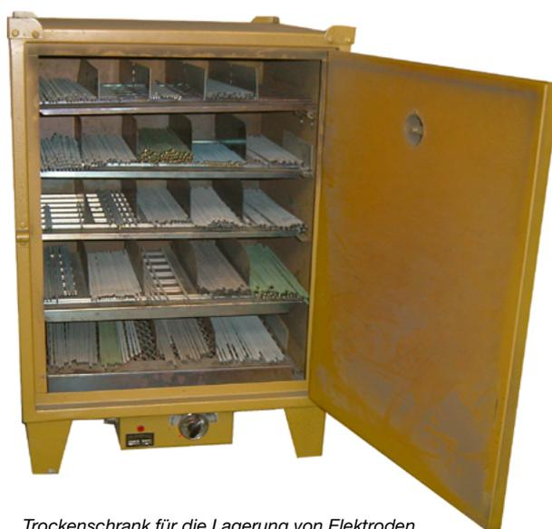
*Trockenschrank für die Lagerung von Elektroden.*
