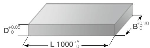
Präzisionsflachstahl mit Bearbeitungsaufmaß 1000 mm
