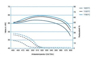
Dieses Anlassschaubild wurde nach der Wärmebehandlung von Proben der Größe 15 x 15 x 40 mm, abgekühlt durch Gebläseluft/ Umluft, erstellt.
