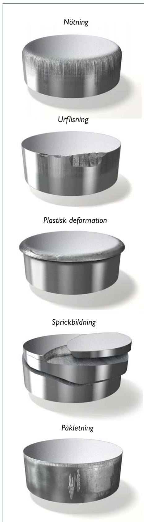
Figur 3. De mest frekventa skademekanismerna hos kallarbetsverktyg.
