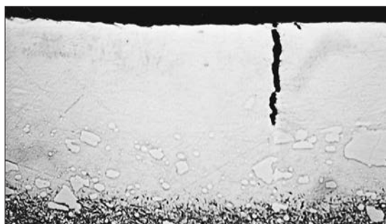
Bild 4. Ytan hos Uddeholm Sverker 21 efter grovgnistning. Det vita skiktet är sprött och innehåller sprickor.
