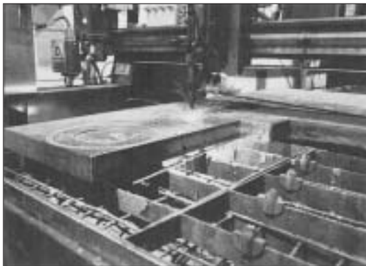
Gas cutting of Uddeholm Formax.
